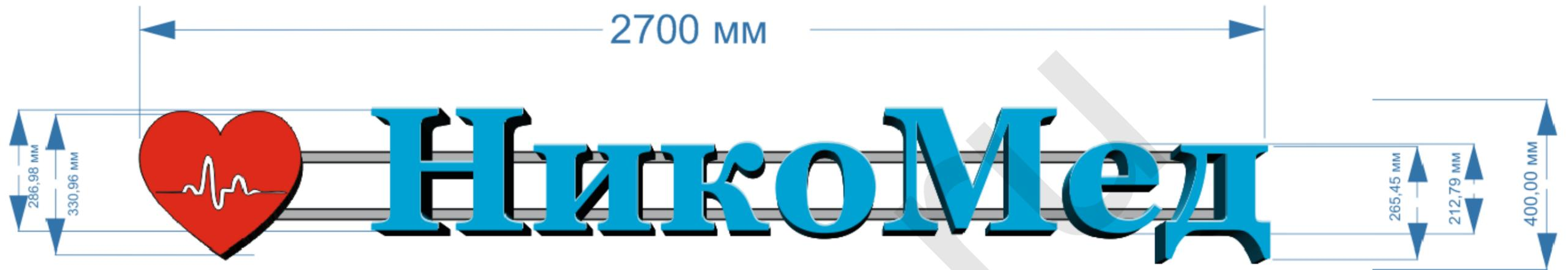
Рекламно-информационная вывеска "НИКОМЕД" состоит из световых (лицевая поверхность) клееных объемных букв и светового (лицевая поверхность) логотипа, расположенных на монтажном подрамнике из профильной трубы 20x20x1,5 мм ГОСТ 8639-82
