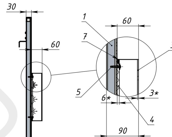
Сварной металлокаркас из стальной трубы 20x20x1,5 ГОСТ 8639-82. Порошковая покраска
